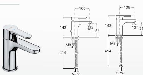
Misturadora monocomando de cano médio para lavatório, corpo liso e ligações de alimentação flexíveis. Abertura em água fria.
