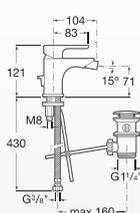
Misturadora para bidé, com prelator orientável, fixador de corrente e ligações de alimentação flexíveis. Cromado.
